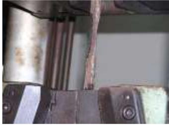
**Gambar 7.** Pengujian tarik baja
