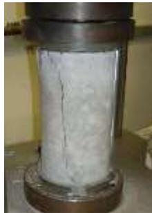
**Gambar 9.** Pengujian tekan beton
